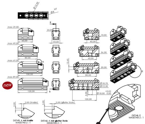
mit Verzahnung zum Einsatz auf SFT Spannschiene
